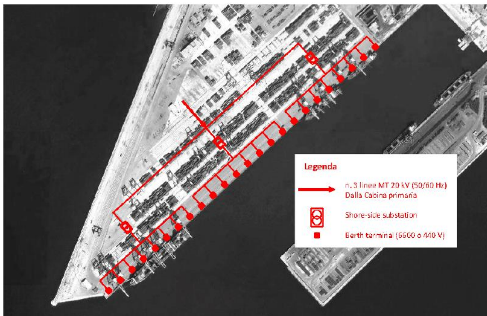
Figura 18: Soluzione 1 per l'elettrificazione del Molo Polisetoriale
