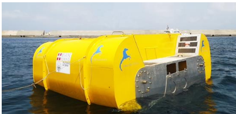
Figura 45: ISWEC (Intertial Sea Wave Energy Converter) - impianto sperimentale generazione elettrica da moto ondoso e FV
