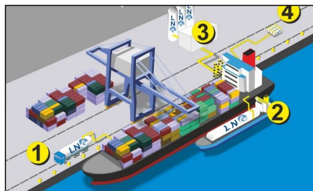
Figura 23: Opzioni di bunkeraggio
