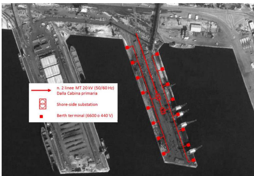
Figura 21: Soluzione per l'elettrificazione dello Sporgente 2
