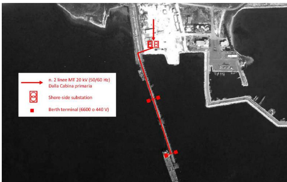
Figura 20: Soluzione per l'elettrificazione del Pontile Petroliero
