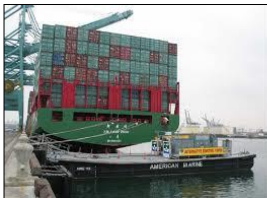
Figura 14: Sistema di alimentazione del tipo chiatta a motore
